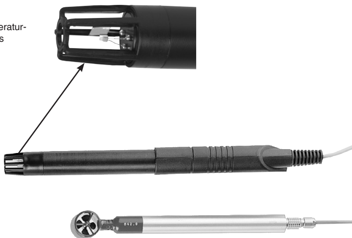
Abb. oben: Temperatur-Feuchte-Kombifühler Abb. unten: Flügelrad-Strömungsfühler
